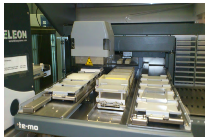
Freedom EVO beim Übertragen der Compounds auf eine 384-Napf Mikrotiterplatte
